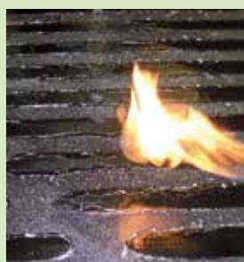
Au cours des premiers instants de flammage, la surface devient initialement opaque
