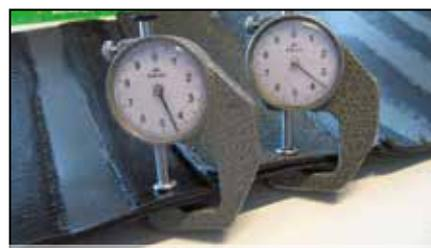
L'épaisseur du chevauchement est inférieure à celle des bandes, garantissant ainsi le maximum de stabilité aux panneaux isolants posés à cheval sur le chevauchement
